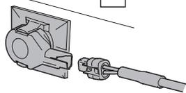
Svorkovnice kabeľu zavrakn te do svorkovnice parkovacich senzor  a zadn  n raznik namontujte zp t na miesto.
